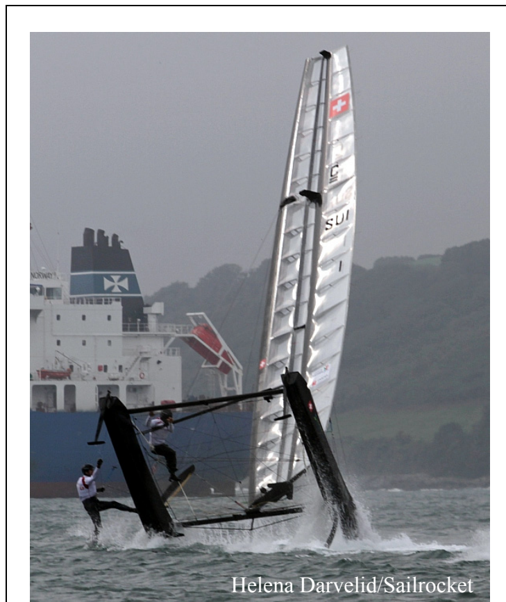
Figure 1.7 Chavirage du catamaran Hydros suite à un enfournement
