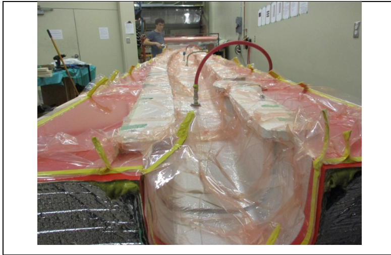
Figure 5.6 Mise sous vide du stratifié de coque
