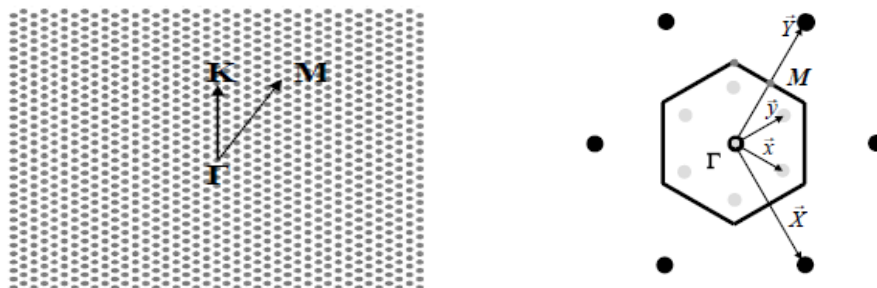
Figure I. 15: Gauche : Réseau direct avec les directions \Gamma K et \Gamma M (les points gris correspondent aux trous d'air dans le semi-conducteur). Droite : Réseau réciproque et zone de Brillouin associée avec les vecteurs de bases X et Y (réseau direct en gris avec les vecteurs de base x et y ).
