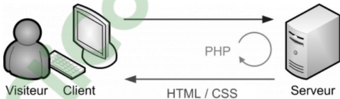
Fig4.8: Principe de fonctionnement d'un serveur Web
