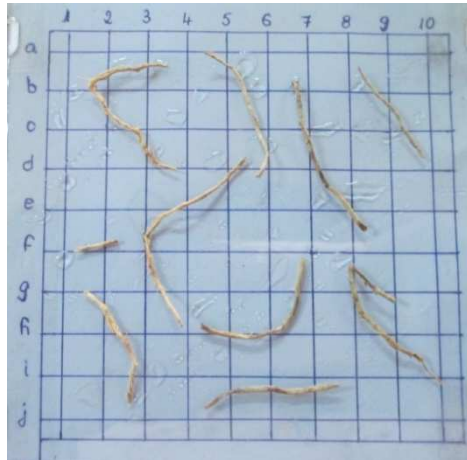
Photo 2 : Comptage des intersections entre les racines et la grille.
