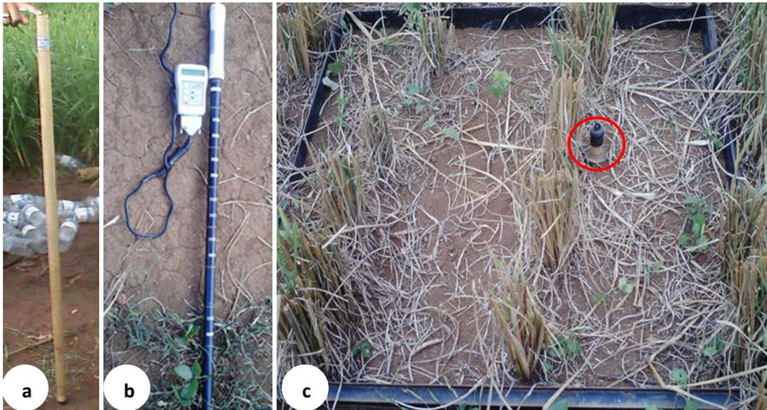
**Cliché 1: Humidimètre avec sonde théta : a) tube à enfoncer dans le sol – b) boîtier composant des capteurs d’humidité – c) sonde mise en place**
