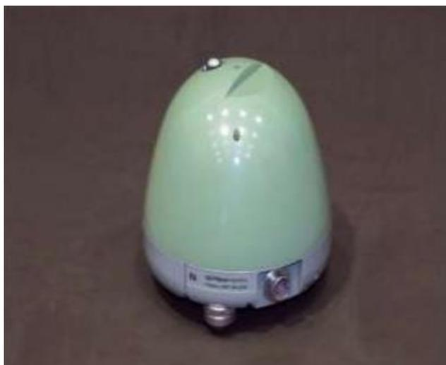
Figure 21 : Trillium 120, capteur
