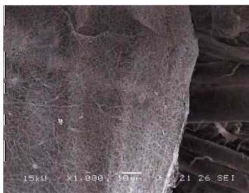
**Figure 4.2 :** NFC/PEO déposées sur les fibres de papier
