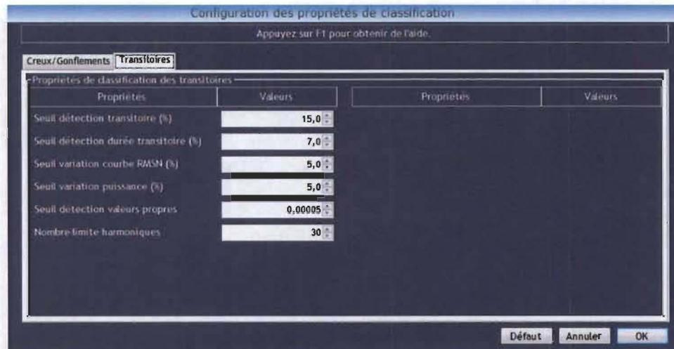
Figure 3-3 - Propriétés de l'algorithme de détection de transitoires
