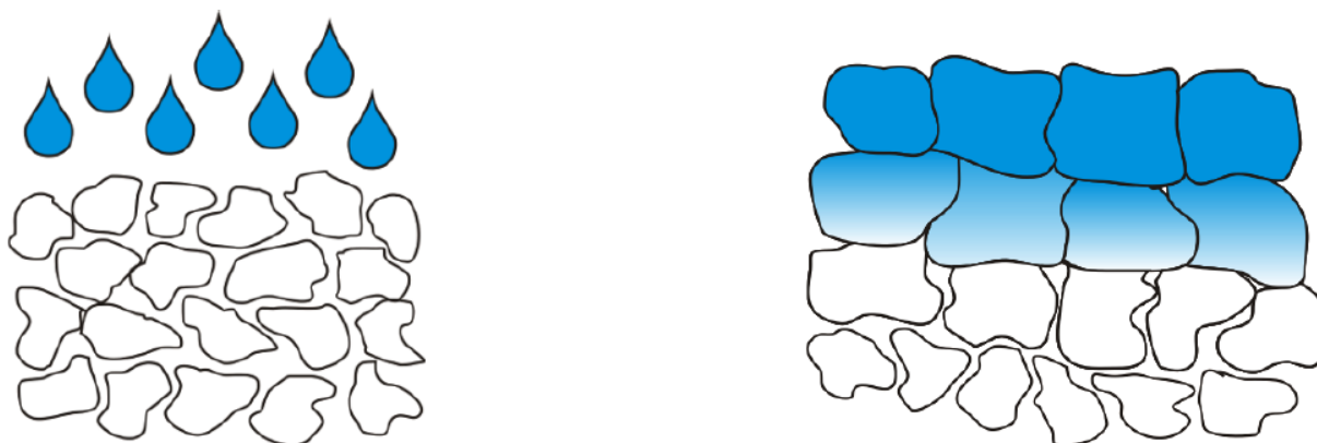
Figure 2.4: Illustration du phénomène de gel-blocking (d'après Buchholz, 2006).
