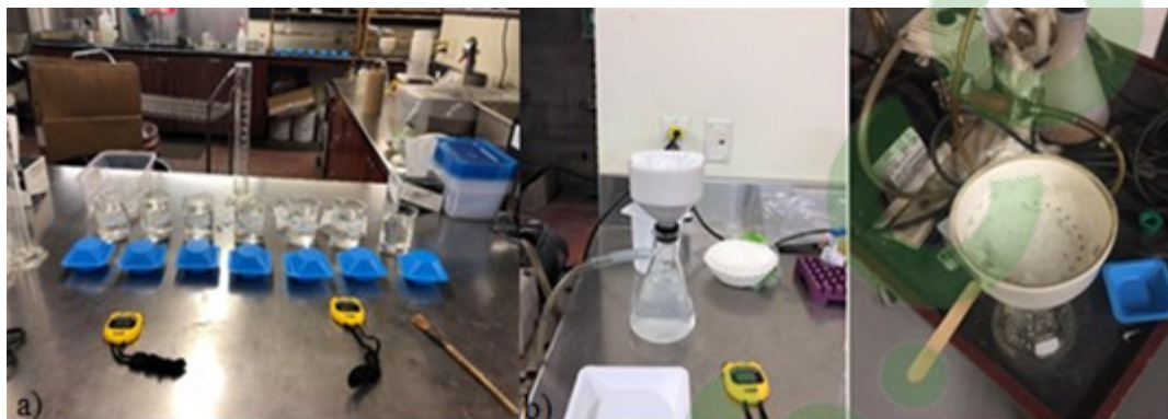
Figure 3.5: Évaluation du taux d'absorption : a) préparation des échantillons pour mesurer le taux de gonflement, b) filtration sous vide.
