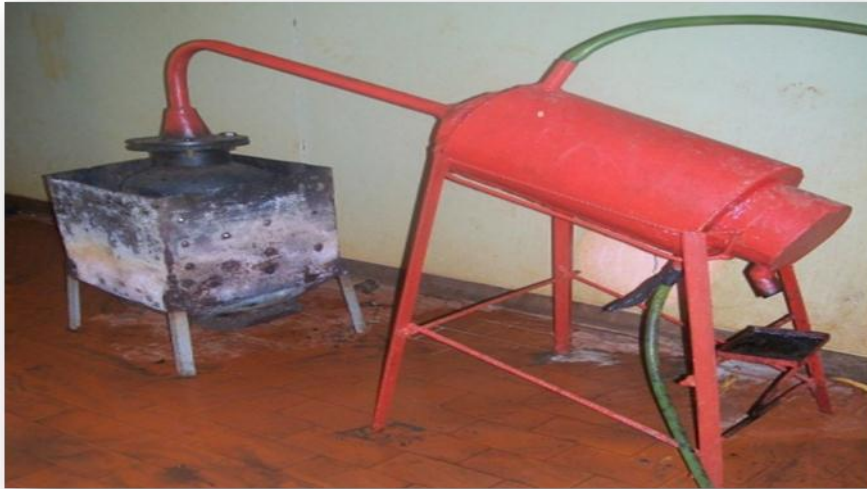
Photo 10: Unité de pyrolyse de bambou.
