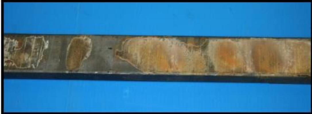
**Figure II-11** : Dégradation due à des décharges d'encoche [38].
