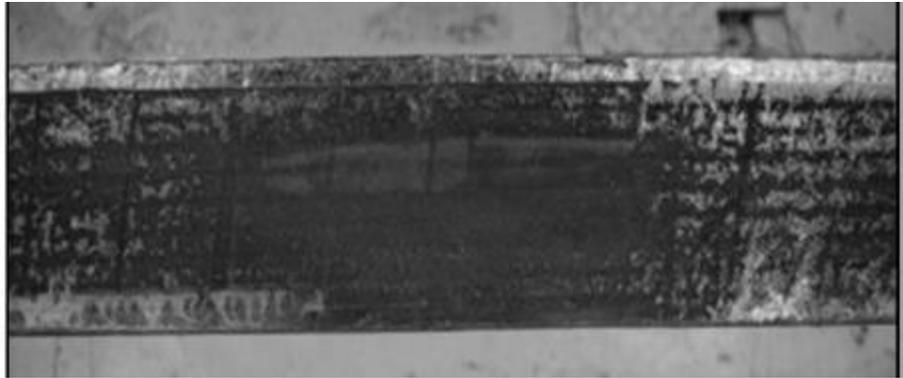
**Figure II-10** : Dégradation due aux décharges partielles internes [37].
