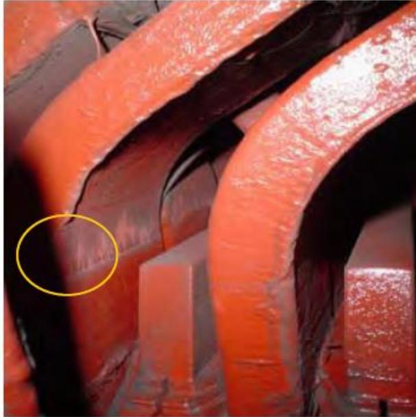
**Figure II-26** : Signe de la présence de DPs après quatre années de service d'une barre statorique [84].
