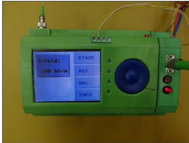
**Figure II-22** : Capteur EO de mesure du champ électrique « WEISSGERBER engineering GmbH » [79].
