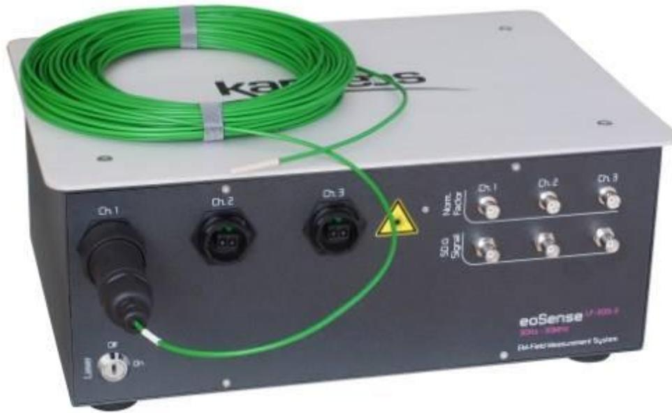
**Figure III-7** : Unité de traitement optoélectronique
