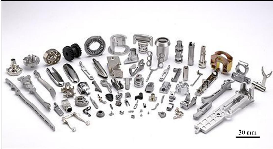
Figure 1.2 Pièces fabriquées par MIM dans différentes industries
