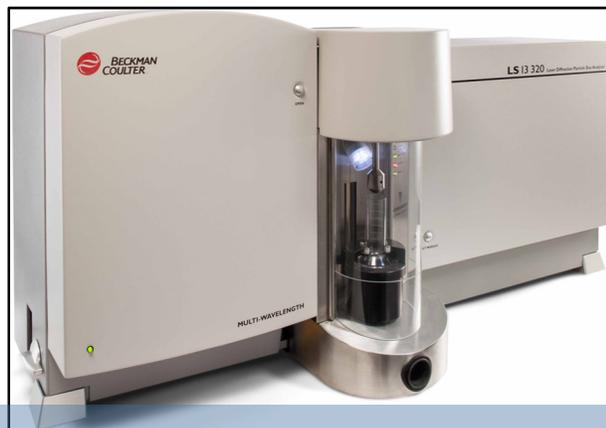
Figure 3.1 Analyseur de distribution de tailles avec système de poudres sèches
