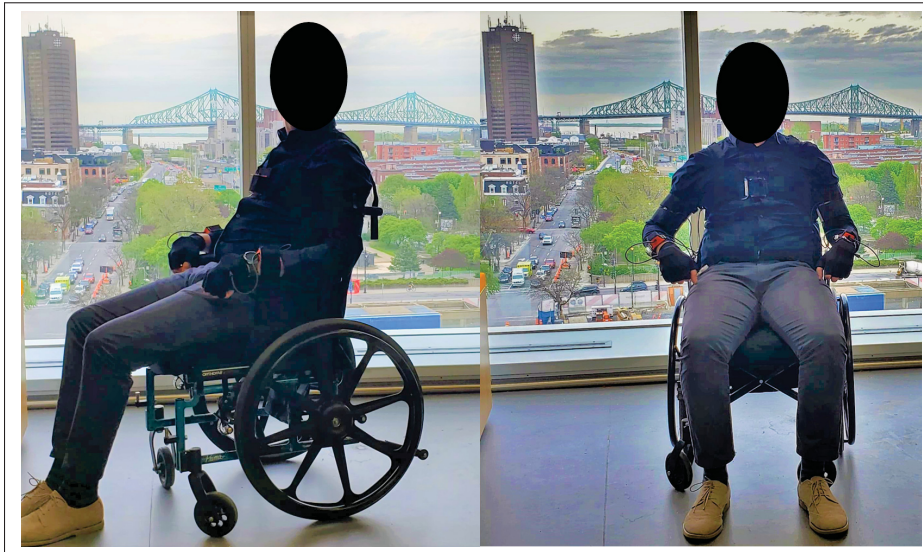
Figure 3.3 Placement des unités inertielles du Xsens
