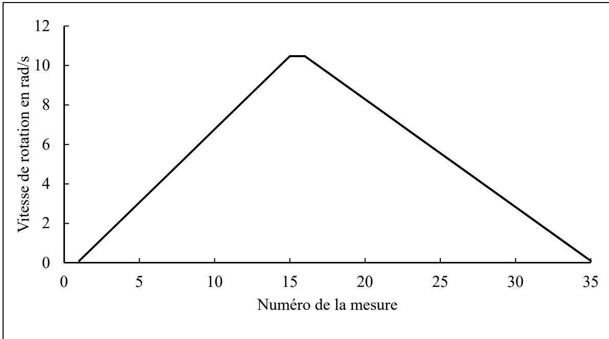
Figure 1.10 Procédure de contrôle de la vitesse de rotation pour effectuer la mesure d'après les recommandations du NIST
