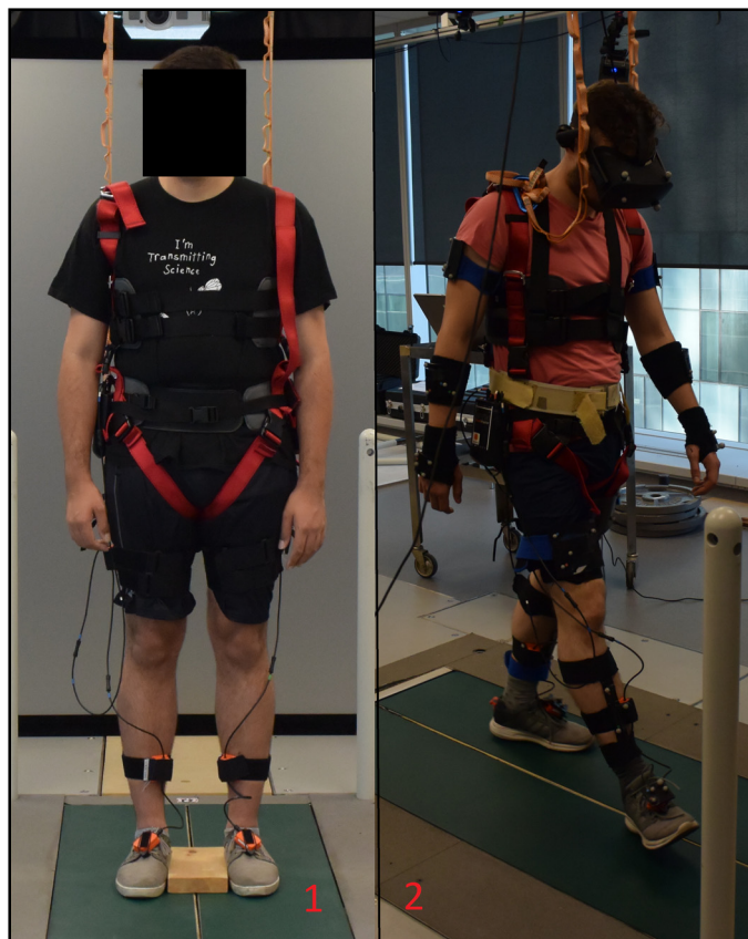
Figure 3.2 (1) Utilisateur avec capteurs inertiels XSens (2) Utilisateur avec marqueurs inertiels XSens et capteurs passifs Vicon
