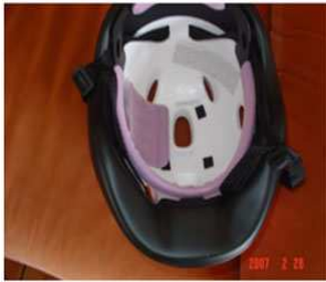
Intérieur d'un casque en polystyrène élastifié
