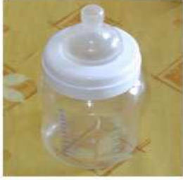
Biberon « incassable » : corps en PMMA, bague en PP et tétine en Silicone (moins résistante aux micro-ondes)
