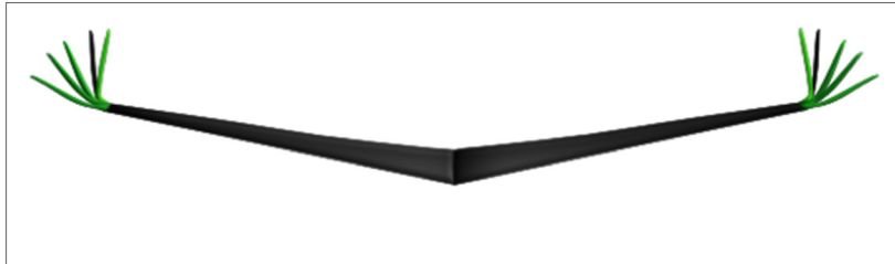
Figure 4.3 Principe de fonctionnement du winglet adaptatif
