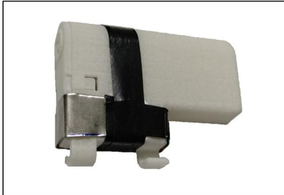
Figure 2.8 Capteur HES avec blindage de mumétal
