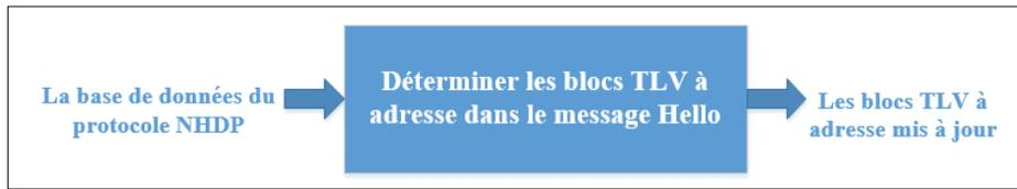
Figure 3.2 La sous-fonction générant les blocs TLV à adresse dans le message Hello
