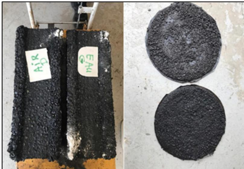
Figure 6.4 Échantillons fabriqués : à droite) complexes ECF + enrobé à chaud, à gauche) galettes d'ECF vierge
