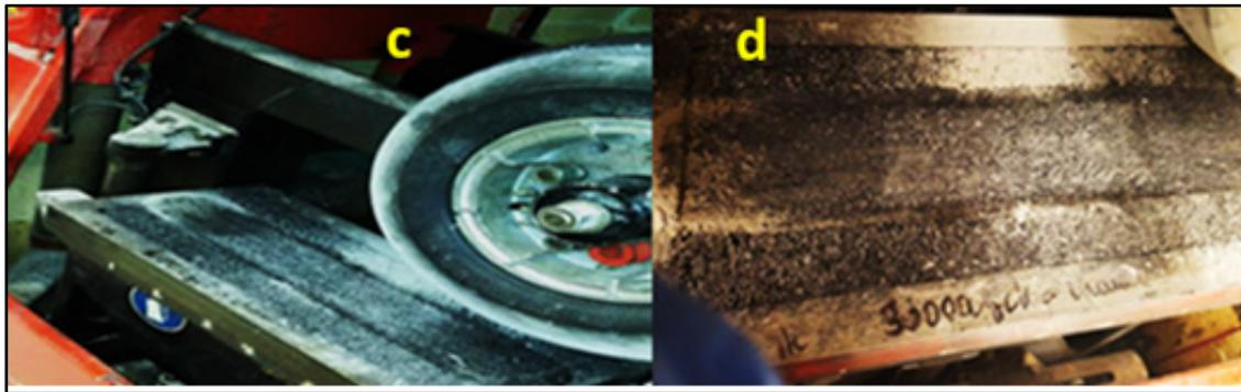
Figure 7.5 Plaques d'enrobé ornières et réhabilitées à l'ECF après à l'essai d'orniérage à 30000 cycles. (a) Plaque d'enrobés à chaud avant orniérage; (b) Plaque d'enrobés à chaud avant orniérage; (c) Plaque d'enrobés à chaud après 10 000 cycles d'orniérage et (d) Plaque d'enrobés à chaud après 30 000 cycles d'orniérage
