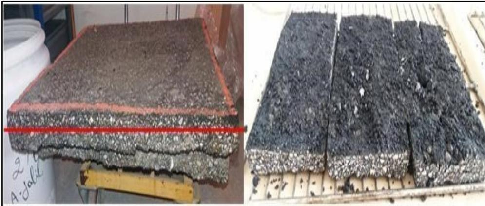
Figure 5.28 Échantillons d'ECF extraits d'un chantier de Probinord
