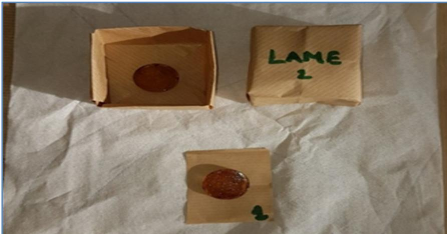
Figure-A VI-2 Lames de KBr utilisées pour le vieillissement UV et thermique
