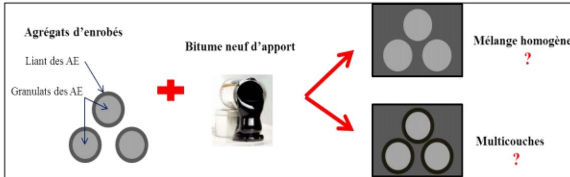
Figure 1.3 Représentation du phénomène de mélange des liants d'un enrobé recyclé
