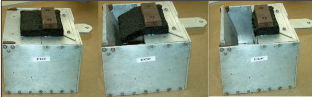
Figure 2.9 *Hilt Cohesion Test*- Mesure du temps de rupture d'une galette d'ECF
