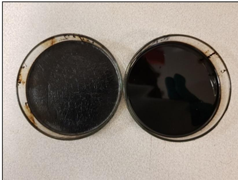
Figure-A VI-3 Boites de pétri après 3200h exposée aux UV (gauche) et non exposée (à droite)
