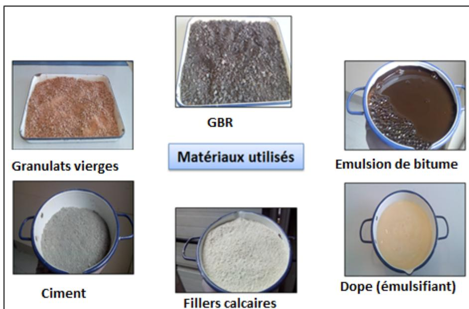
Figure 3.1 Récapitulatif des matériaux utilisés pour les essais
