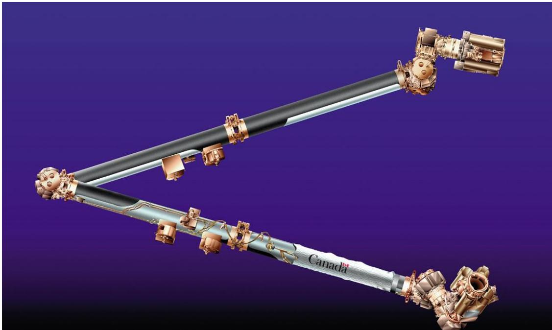
Figure 0.3 : Schéma de la structure de Canadarm2 (MDRoboticsLtd.)
