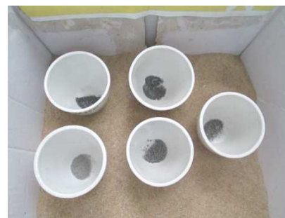
Fig. 23- Les échantillons après deux heures de calcination dans un bac de sable
