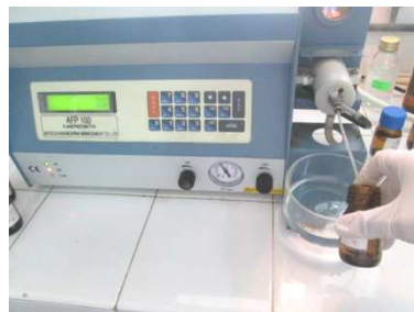
Fig. 26- La lecture par le spectrophotomètre à flamme
