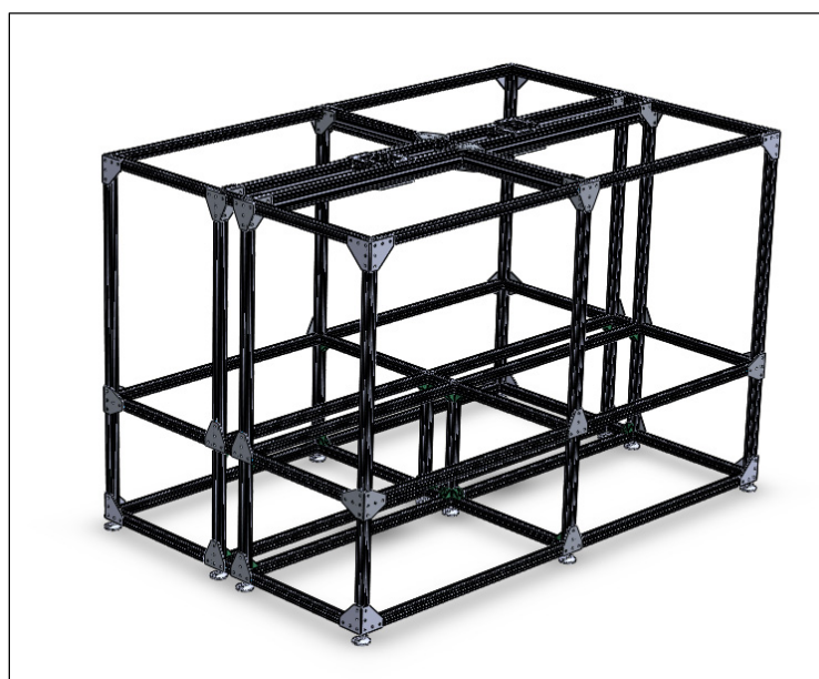
Figure 2.14 Structure d'aluminium fournie par la compagnie Vention
