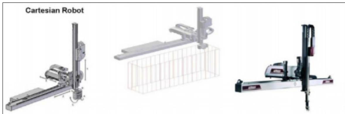
Figure 2.3 Robot de type cartésien Tirée de IFR (2016)
