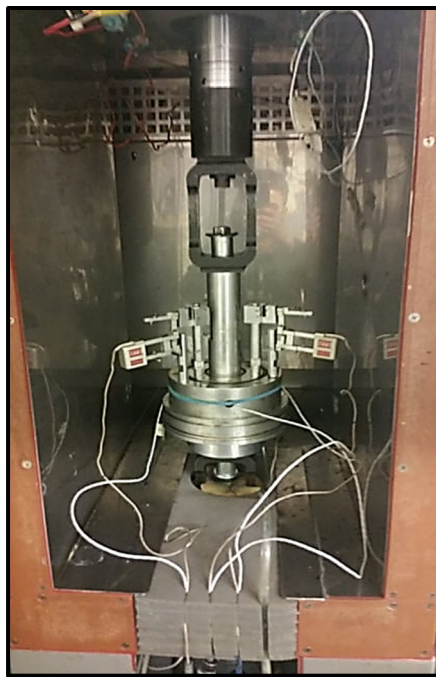
Figure 3.3 Essai de cisaillement annulaire mis en place sur la presse MTS
