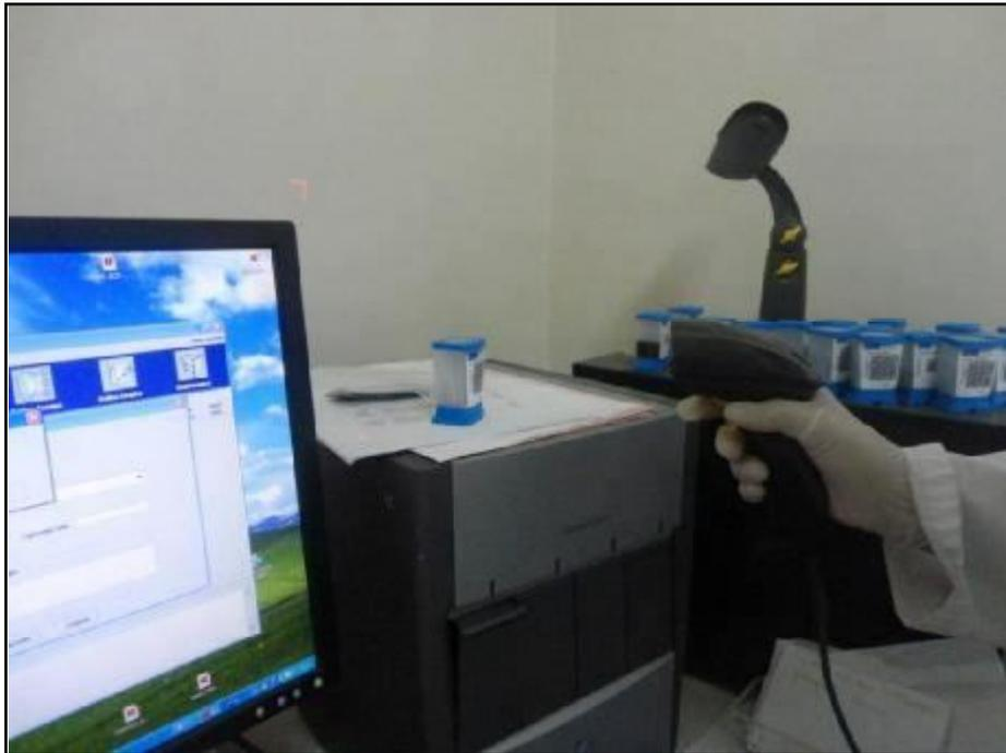
Figure 44 : Lecture du code-barres de la cartouche à l'aide d'un scanner.
