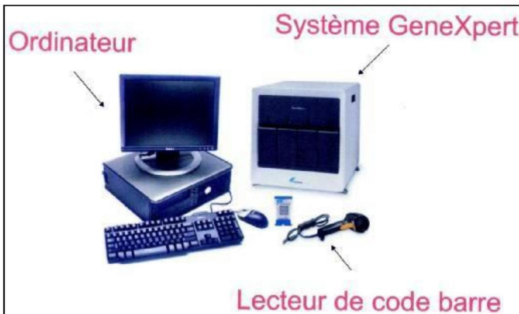
**Figure 31** : Instruments nécessaires pour la technique GeneXpert [171].
