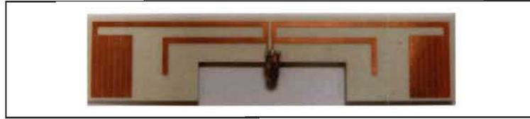
Figure 6-41 : Antenne double bande ISM fabriquée
