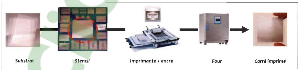
Figure 5-9 : Étapes d'impression d'un circuit imprimé par sérigraphie
