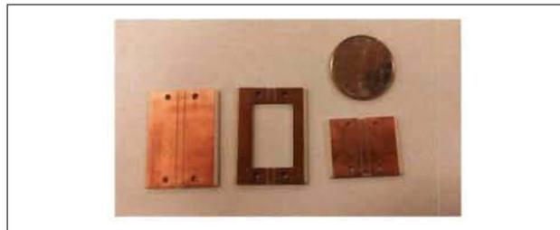
Figure 5-2 : Kit PCB pour la calibration TRL
