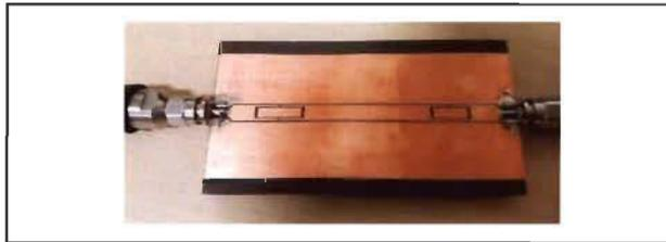
Figure 6-28 : Multi-résonateur fabriqué
