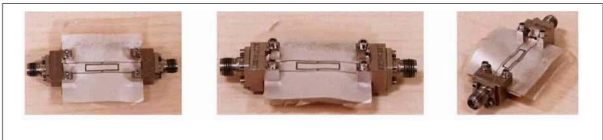
Figure 5-29 : Capteur imprimé sur NCTO/PVOH-2
