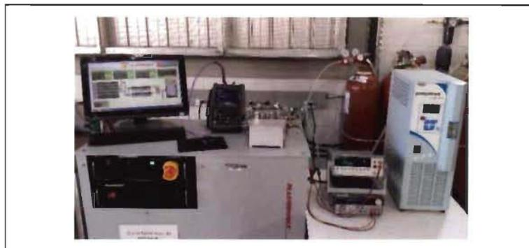
Figure 3-10 : Photo du banc de test d'humidité
