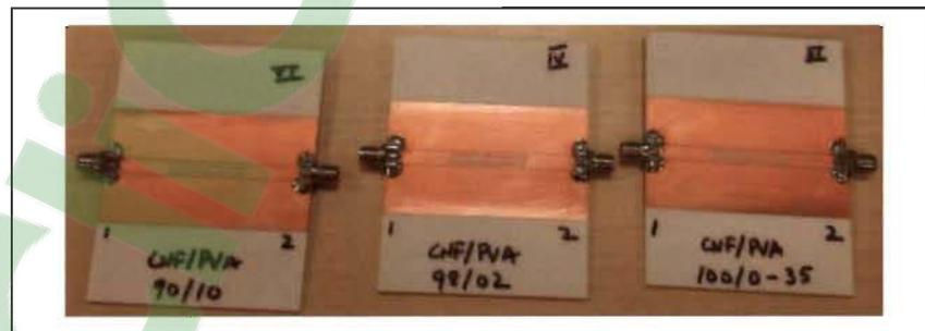
Figure 4-21 : Photo des résonateurs CPW fabriqués
