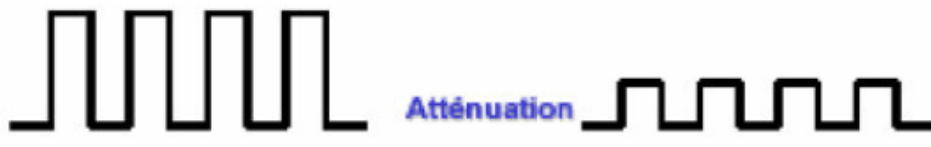
Figure I.16 : L'affaiblissement d'une fibre optique.
