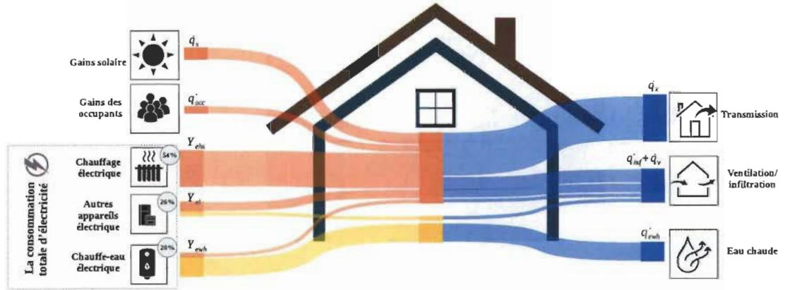
Figure. 3-2 Les flux d'énergie dans le bâtiment.
