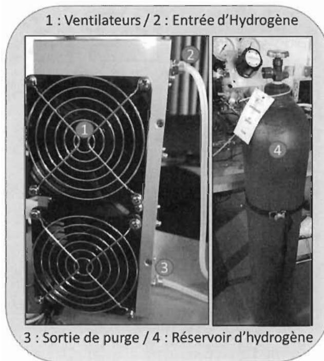
Figure E.1 La PEMFC utilisée dans le banc d'essai
