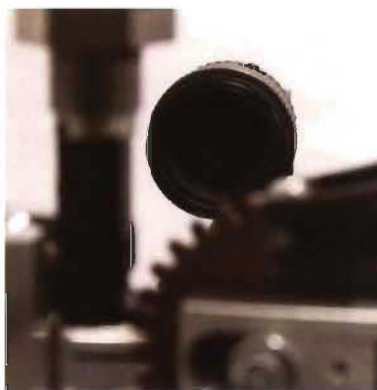
Figure 25 - Caméra pour mesure de la fissure
