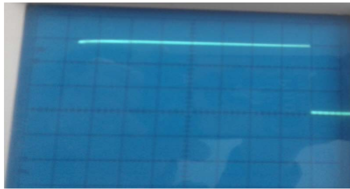
Figure 3.5 : Signal du monostable (Pin10 du IC2).
