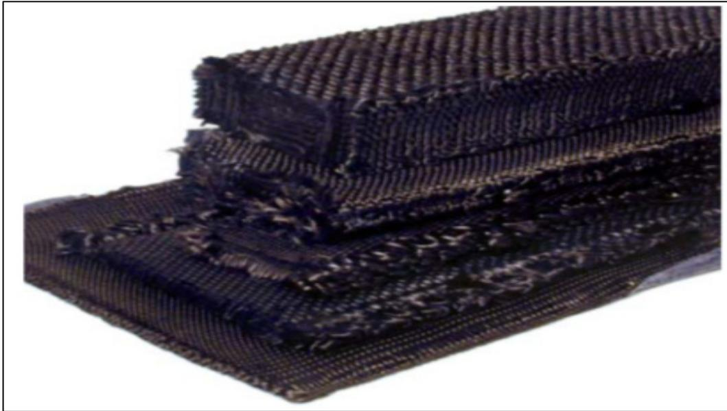
Figure 1.9 Exemple de préforme 3D 3Weave™
