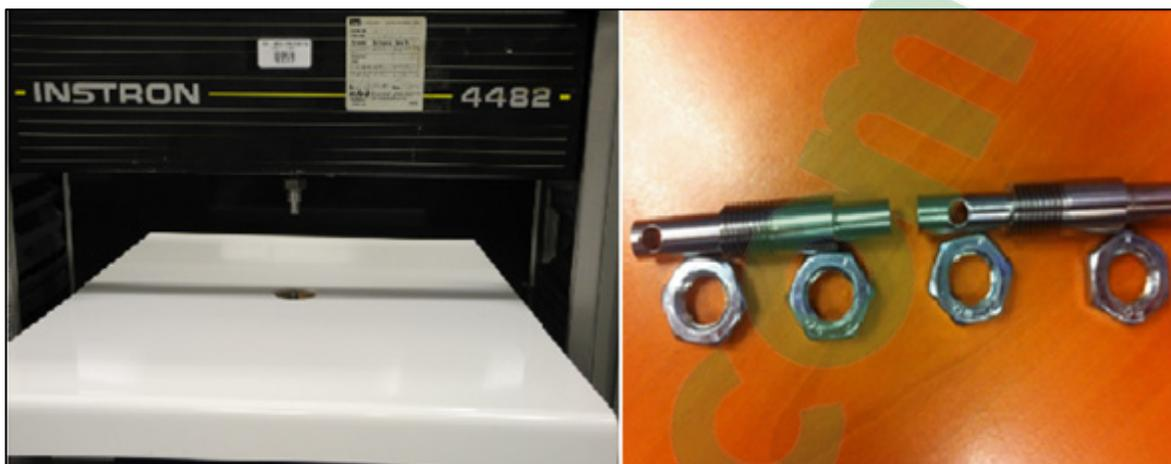
Figure 3.4 Dispositif de compaction localisée : Machine Instron 4482 et plateaux de compaction
