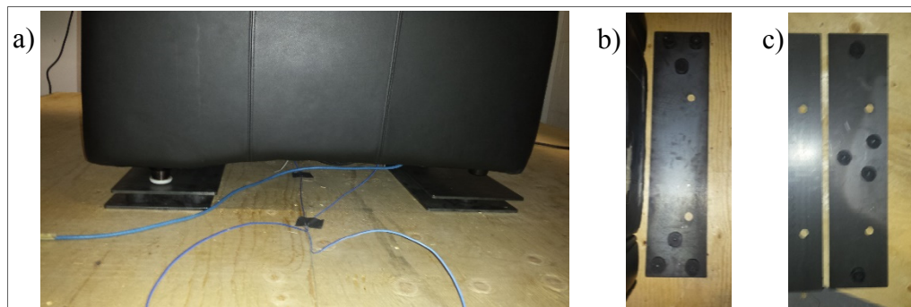
Figure 2.15 : Laminés de caoutchouc et métal a) Sous les vérins, b) Disposition avant et c) Disposition arrière
