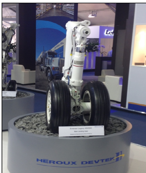
Figure 1.23 Train d'atterrissage de l'avion Embraer Legacy
