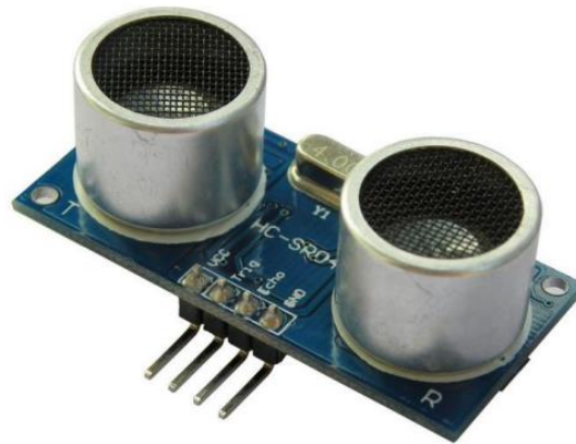
Figure 4.3: capteur ultrason HC-SR04
