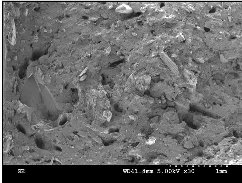
Figure 3.17 Étude microscopique de la surface de rupture d'un échantillon de la F2 de l'essai d'Impact
