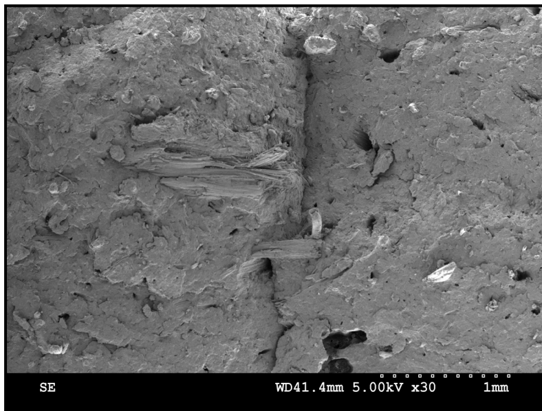
Figure 3.18 Étude microscopique de la surface de rupture d'un échantillon de la F3 de l'essai d'Impact
