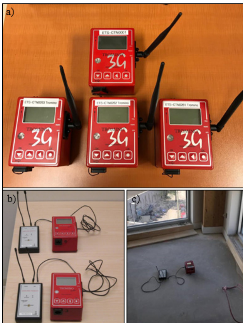
Figure 3.2 Capteurs Trominos : a) avec antennes radio, b) avec amplificateur radio, c) expérience en cours avec amplificateur radio
