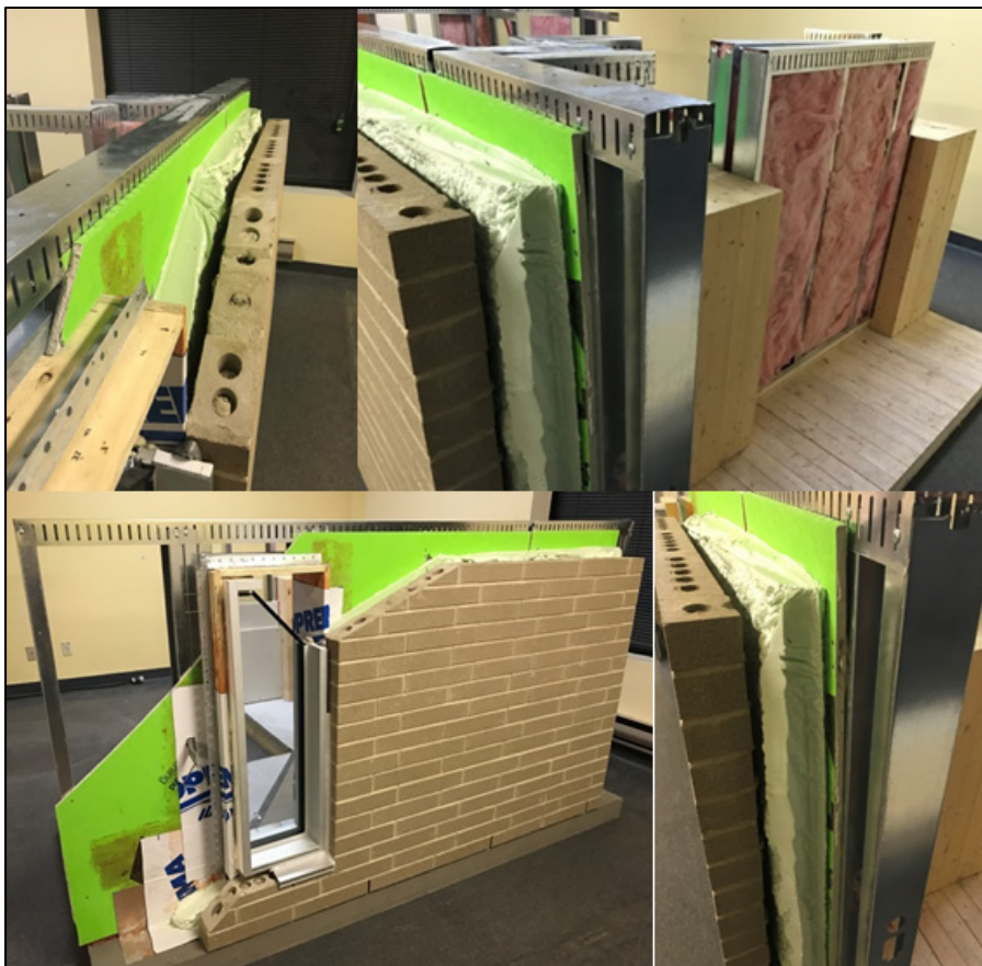
Figure 2.6 Photographies de coupe des façades de ARBORA
