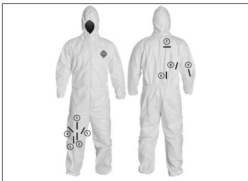
Figure 3-3 : Positionnement des capteurs sur les combinaisons
