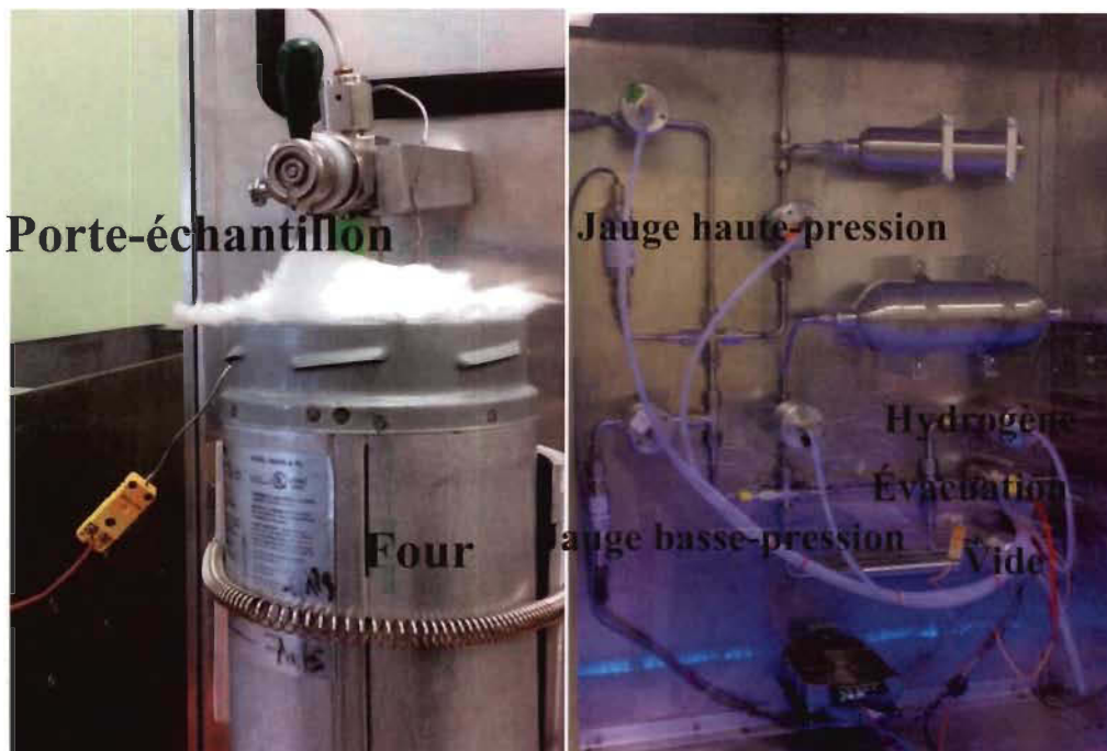
Figure 2.8 : Appareil de titration de type cycleur et le porte-échantillon prêt à l'analyse
