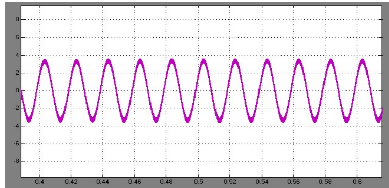
Figure I.36: courant de sortie de l'onduleur pour la deuxième commande
