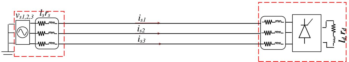
Figure 3-2 : Schémas de charge non-linéaire alimentant une charge r-l connecté au réseau triphasé à trois fils.
