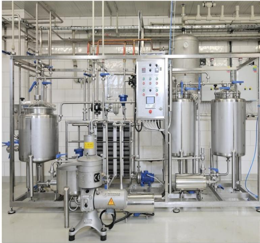
Figure 14 : machine de pasteurisation[10]
