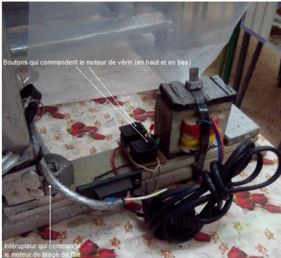
Figure 39 : Image descriptive de la partie commande. [13]
