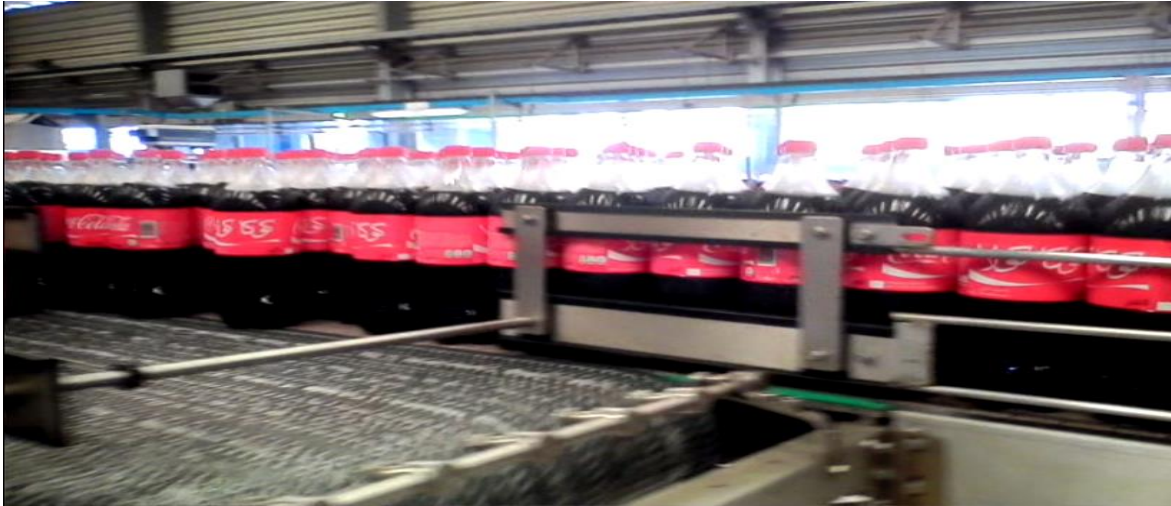
Figure 7 : PET 2L acheminées vers les guides d'entrée de la fardeleuse.[7]
