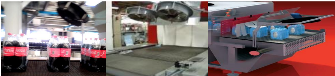
Figure 31: Refroidissement des fardeaux.[4 et 15]
