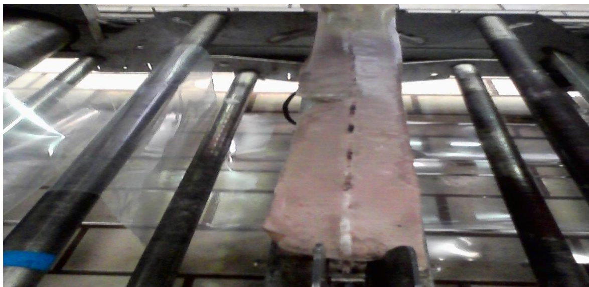
Figure 25: Le met de l'extrémité du film dans la barre de soudure .[7]
