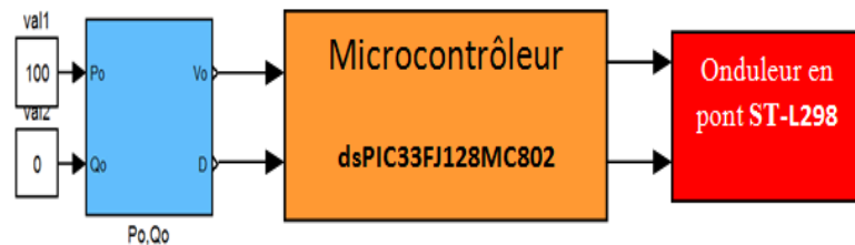
FIGURE III.9 – Schéma synoptique du principe d'envoi de la puissance active et la puissance réactive
