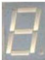
Figure 1.35 : Un afficheur 7 segments.
