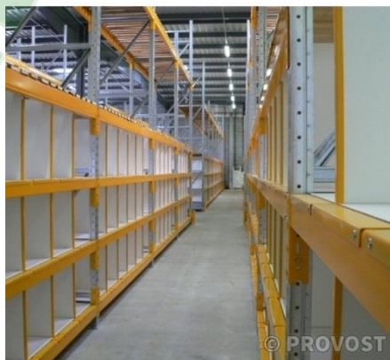
Figure 1.4 : Une allée séparant deux racks de stockage
