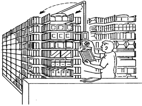
Figure 1.11 : AS/RS à carrousel
