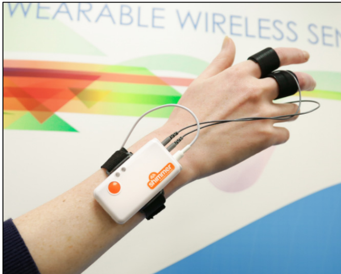
Figure 3.4 Le capteur Consensys GSR mesurant l'activité électrodermale
