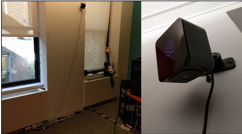
Figure 3.1 Émetteurs infrarouges inclus dans le système de réalité virtuelle HTC Vive 2
