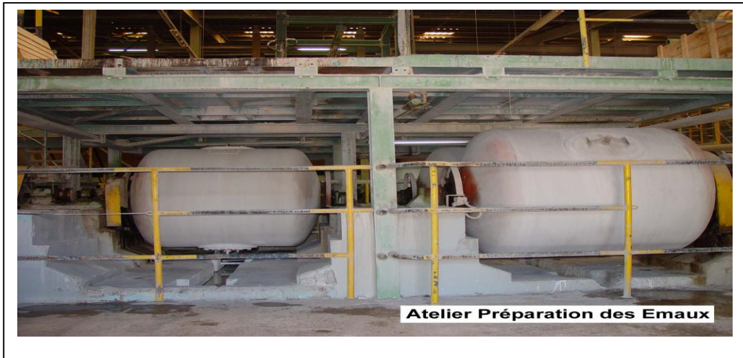
Figure II.10 : Les moulins à tambour pour la préparation de l'émail et l'engobe.
