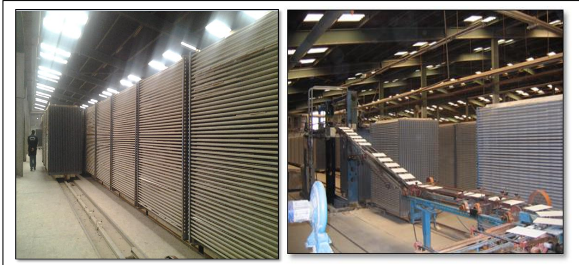
Figure II.17 : Stockage de biscuit émaillé dans des box.
