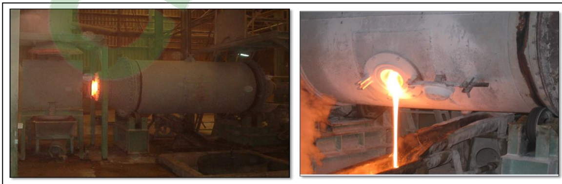
Figure II.9 : Le processus de fusion des frites.
