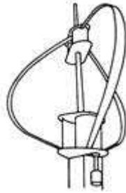
**Figure2-8.** Schéma du rotor de Darrieus[11]
