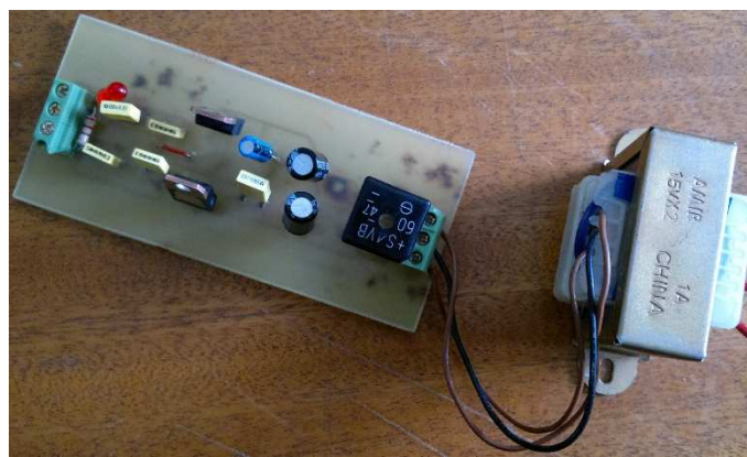
Figure 3.17 : Photo d'alimentation \pm 15v .
