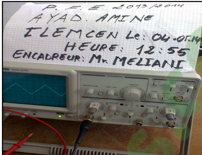
Figure 3.10 : Génération de l'onde triangulaire.
